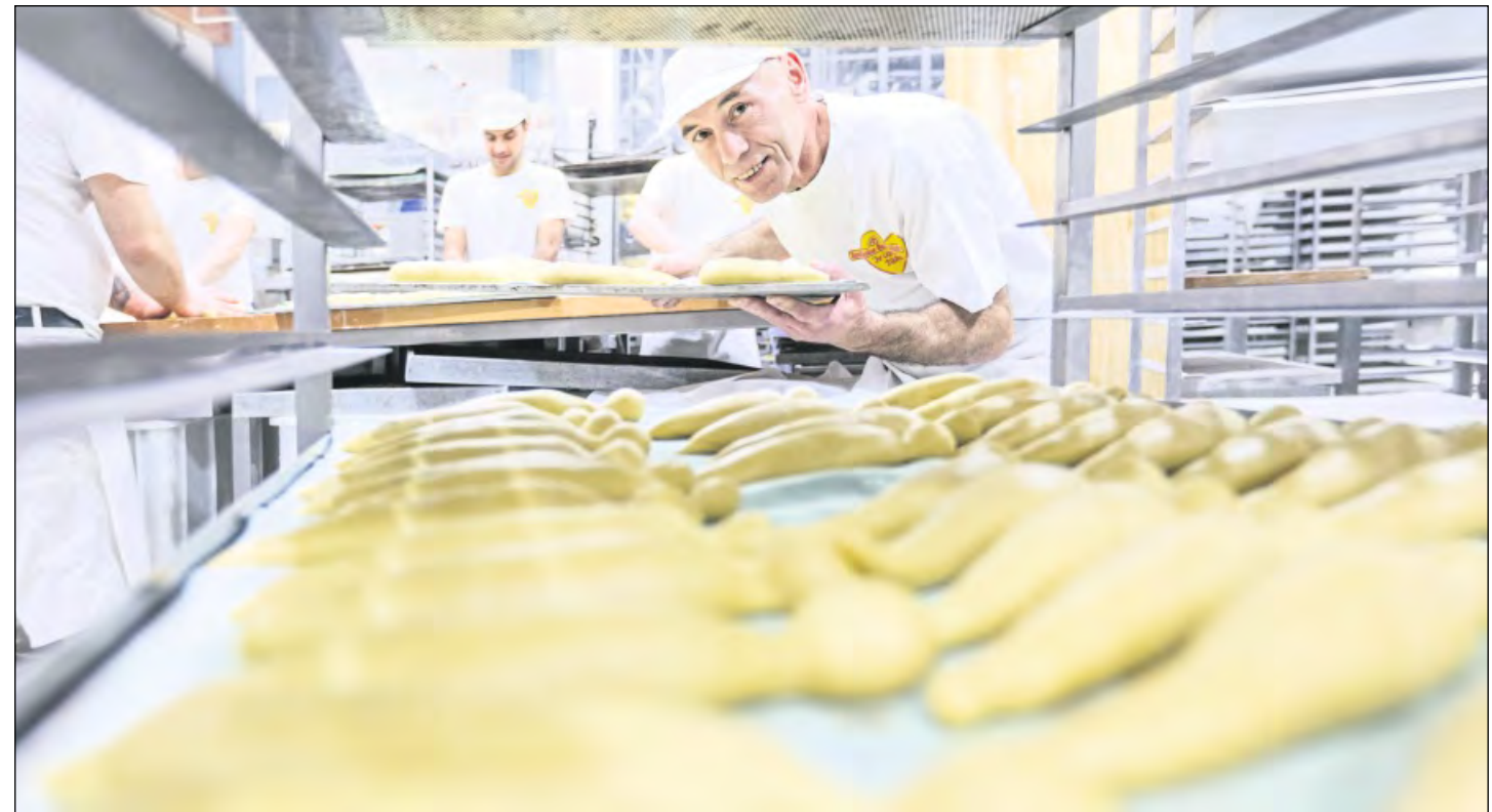
ZUM REINBEISSEN: 200 Dambedeis kommen auf ein Mal in den Thermo-Ofen. Sieben Minuten lang werden sie darin bei 260 Grad Celsius gebacken. Davor ist bei der Badischen Backstub' viel Handarbeit.
